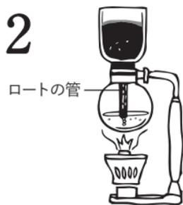
2 フラスコ内のお湯が沸騰してくると、蒸気圧によってロートの管からお湯が上昇していきます。
