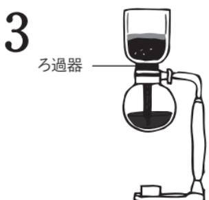
3 お湯がすべて上昇したら、1分程沸騰させ、火を止めます。すると、ろ過器でろ過された抽出液がおりてきます。
